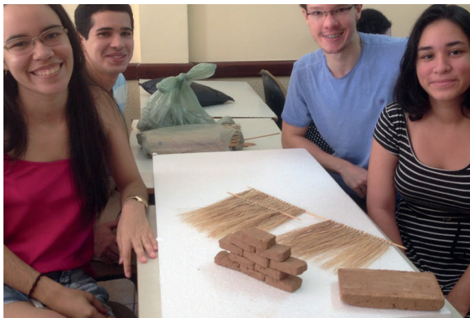
Figura 3 – Tijolo de adobe e amarração de cobertura com palha de piçava.
