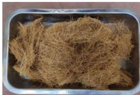
Figura 5. Fibras de Bambu.
