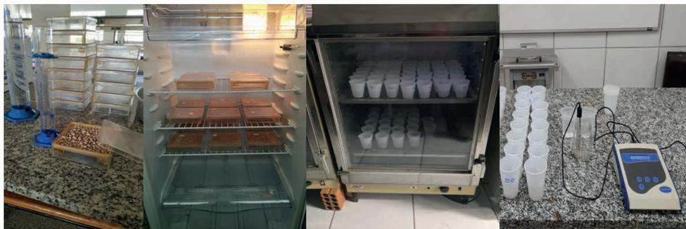
Figura 6. Análises de envelhecimento acelerado e condutividade elétrica, exemplos de análises laboratoriais de qualidade fisiológica. Fonte: SALLES, J. S. 2022.
