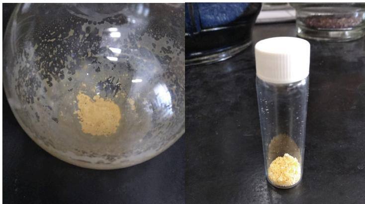
Fig.19: Produtos purificados após a cromatografia de coluna: produto metassubstituído e produto ortossubstituído.
