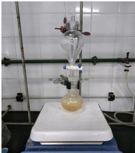
Fig.3: Reação de síntese da 3-clorofenilazida.
