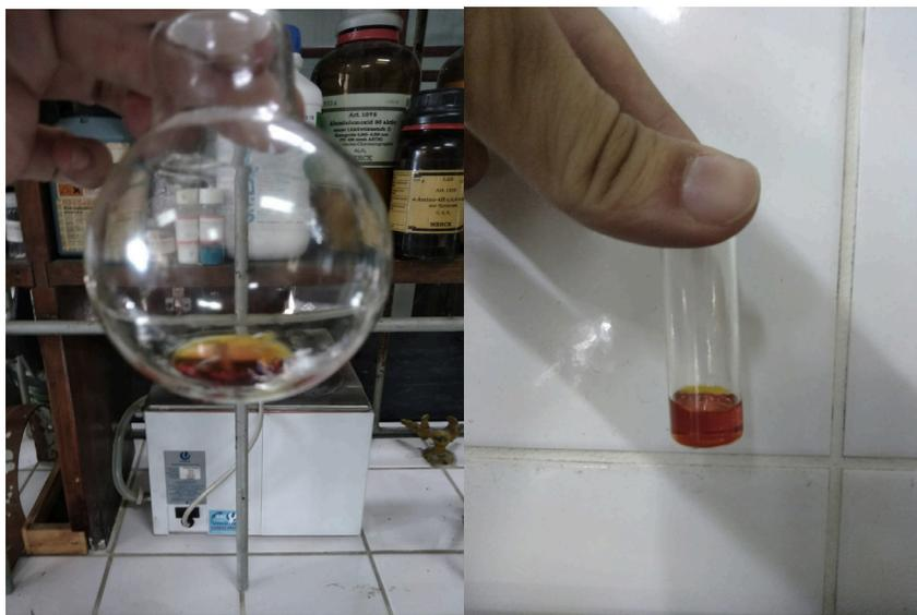
Fig.6: 3-clorofenilazida após ser retirada do rotaevaporador.
