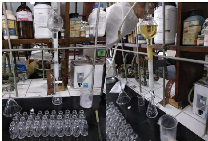
Fig.16: Vidraria utilizada na cromatografia de coluna.
