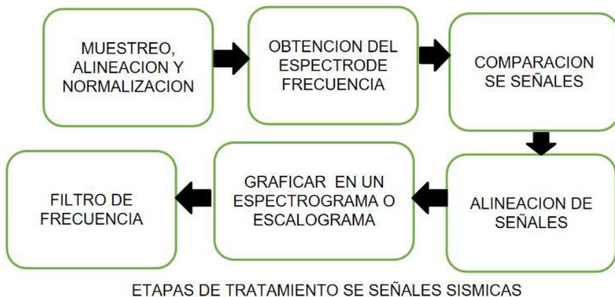
Figura 12. Esquema de las etapas necesarias para el tratamiento de la señal de un sismo. Fuente propia.
