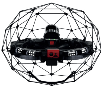
Figura 2 – RPAS modelo Elios 3 com sistema SLAM embarcado. Fonte: FLYABILITY, 2023.
