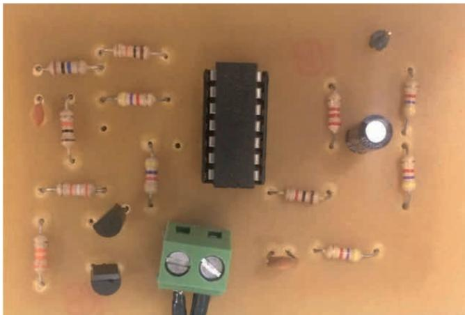
Figura 9 - Circuito modulador prototipado.
