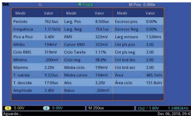
Figura 26 - Folha de dados PWM com Duty cycle a 1.1%
