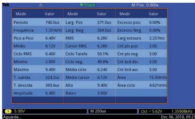
Figura 12 - Folha de Dados Onda triangular na saída do oscilador.
