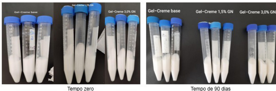
Figura 3 – Imagens representativas das amostras após o teste de centrifugação nos tempos zero e 90 dias de armazenamento.
