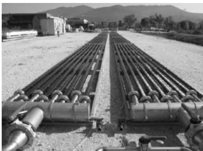
**Figura 2.5** – Exemplo de fotobiorreator tubular tipo manifold
