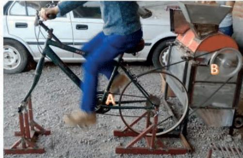
Figura 12 – Prototipo: (A) Bicimódulo; (B) Módulo de proceso.
