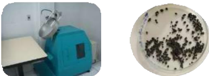
Figura 2: Granulador de prato e fertilizante peneirado após granular.
