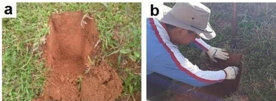
Figura 1: Coleta da amostra a) Abertura da minitrincheira; b) Retirada da amostra
