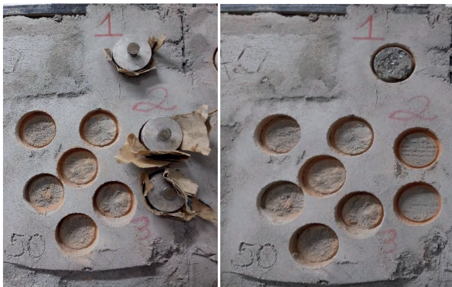
Figura 7 – Ensaio de aderência à tração do corpo de prova com 50g de cola
