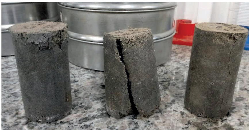
Figura 6 – Corpos de prova convencionais rompidos
