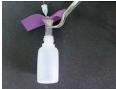
Figura 7- Eppendorf montado e sendo acoplado no frasco opaco para manipulação do conjunto durante a instrumentação.
