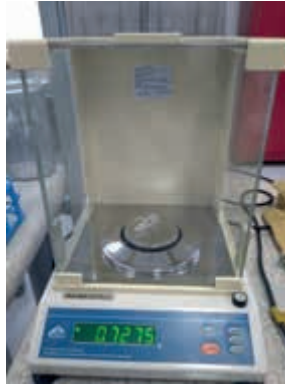
Figura 6- Balança analítica de precisão com o Eppendorf sendo pesado antes da coleta de debris após a instrumentação.
