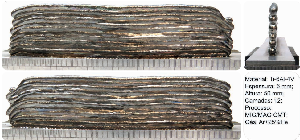
FIGURA 3. Aspecto superficial dos ambos lados da parede e macroestrutura da seção transversal da parede depositada com modo CMT.
