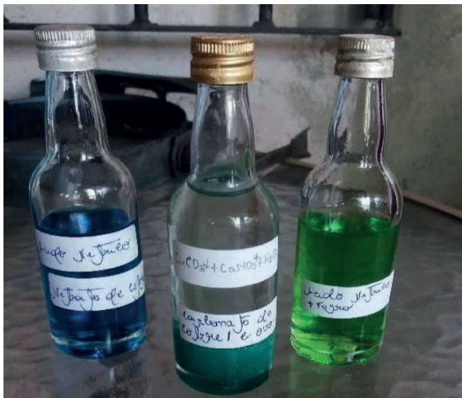
Figura 8: Solução de ácido nítrico (à direita); solução de ácido nítrico e ferro (à esquerda), solução neutralizada com casca de ovo (ao centro).
