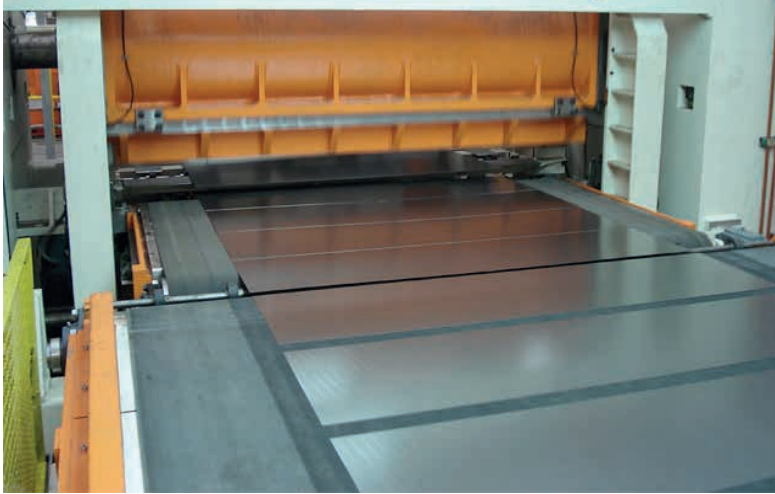
Figura 3 - Linha de Corte Transversal - Produto Final
