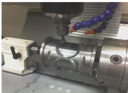
Figura 2. Processo de fresamento com utilização da técnica MQF
