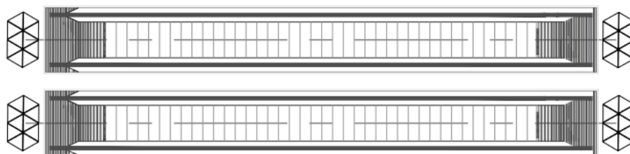
Figura 3 – Escadas rolantes e plataformas piezoelétricas
