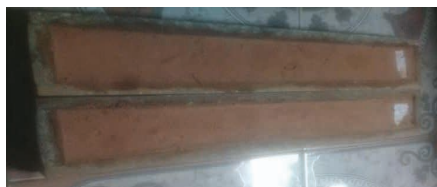
Figura 3. Ensaio da caixa com 1% e 2% de fibra de malva
