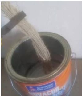
Figura 1. Fibra de juta sendo embebida em resina acrílica.
