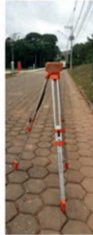
Figura 2 – Leitura da distância para o alvo prisma, tijolo e bloco de concreto
