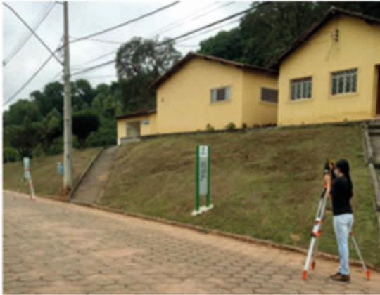
Figura 2 – Leitura da distância para o alvo prisma, tijolo e bloco de concreto
