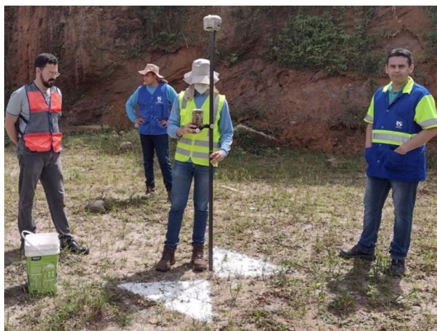
Figura 2: Equipe da MRTech Engenharia coletando ponto de apoio com receptor GPS do tipo “Rover”.
