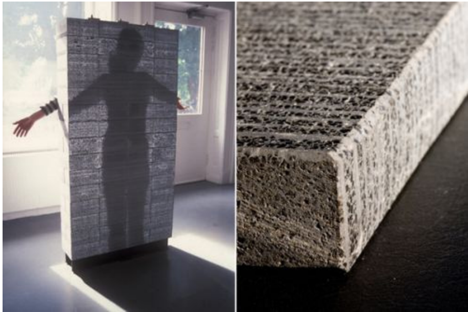
Figura 2 – Hormigón transmisor de luz.
