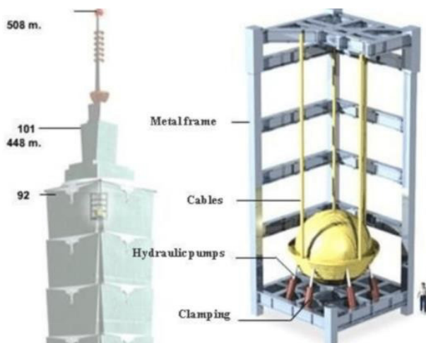
Figura 7 – Representação esquemática da aplicação do “TMD” no edifício Taipei 101, Taiwan.
