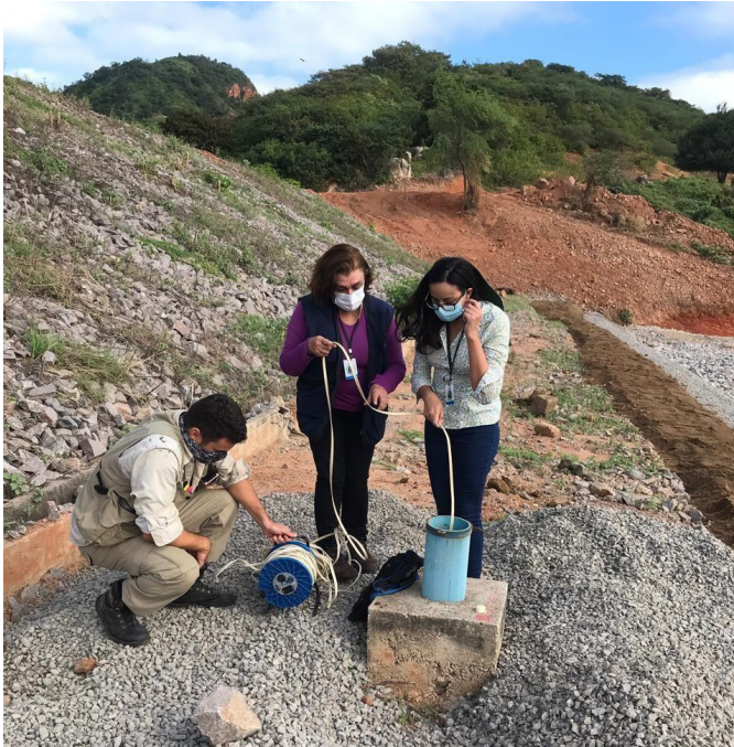
Figura 5 – Realização da leitura do nível de água com o uso de um sensor elétrico no piezômetro 5 da barragem principal.
