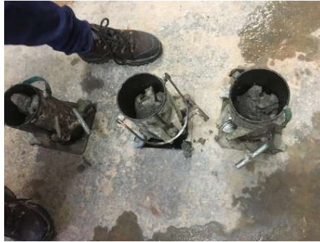
Figura 6 – Moldagem de corpo de prova [Autoria própria]
