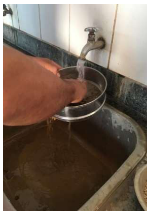
Figura 9 – Ensaio de determinação de material fino passante na peneira de 0,075 mm [Autoria própria]
