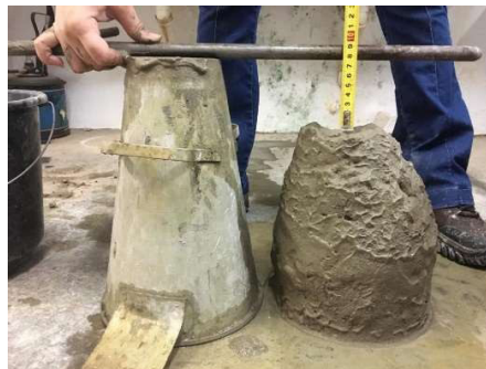
Figura 15 – Abatimento para substituição com 12,5% do pó da pedra Morisca [Autoria própria]
