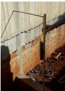
Figura 6 – Barra de 40 cm com 5 kgf de carregamento
