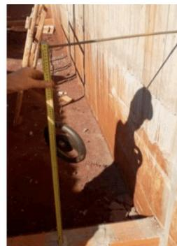
Figura 7 – Barra de 40 cm com 3 kgf de carregamento
