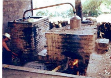
Figura 6. Molienda, con tahona, del agave cocido y destilación del mosto fermentado en alambique.
