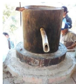
Figura 5. Destilador de madera “tipo filipino”, para destilar la Raicilla.
