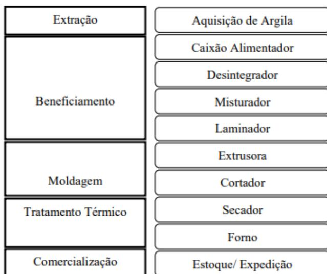
Figura 1 – Processo produtivo da indústria da cerâmica vermelha [4].
