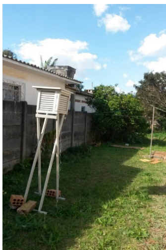
Figura 12 Miniabrigo meteorológico instalado ponto E a Oeste da área da Mata, com termo-higrômetro para registro da temperatura do ar e da umidade relativa.
