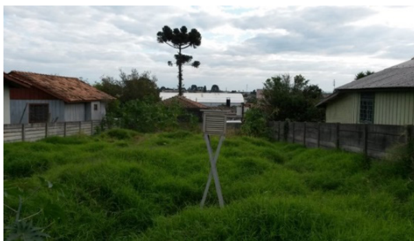
Figura 6 Miniabrigo meteorológico instalado Ponto B, com a porta voltada para o sul, sobre o suporte a 1,5 m da superfície.
