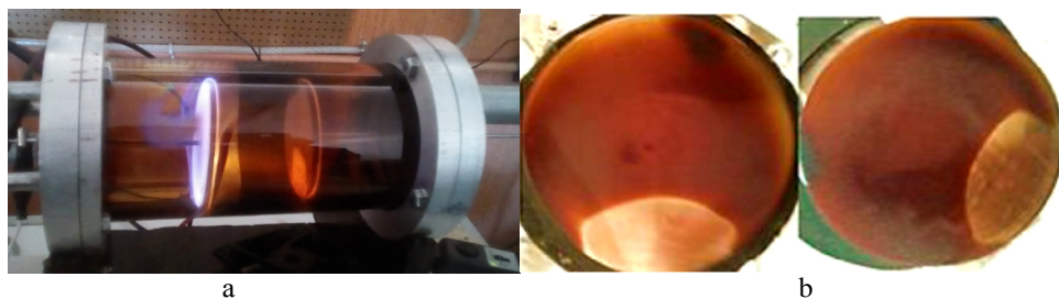
Figura 4. Descarga luminiscente en el reactor (a) y películas de polipirrol y polipirrol dopadas con yodo (b).
