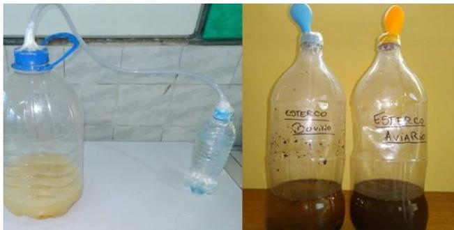
Figura 1: Modelos dos Biodigestores 1 e 2.
