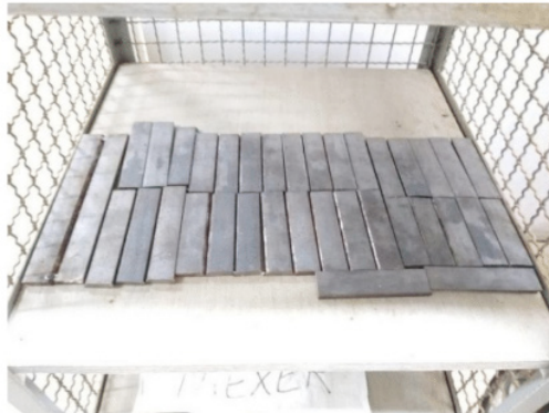
Figura 4 – Chapas de 6 mm para realizar a soldagem
