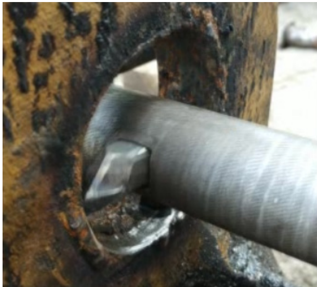
Figura 8. Visualización de la interfaz de contacto entre el housing y la herramienta de corte.
