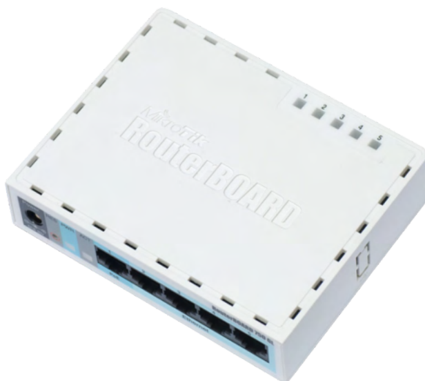
Figura 7 - RB750G (Roteador equipado com sistema de medição e geração de tráfego)
