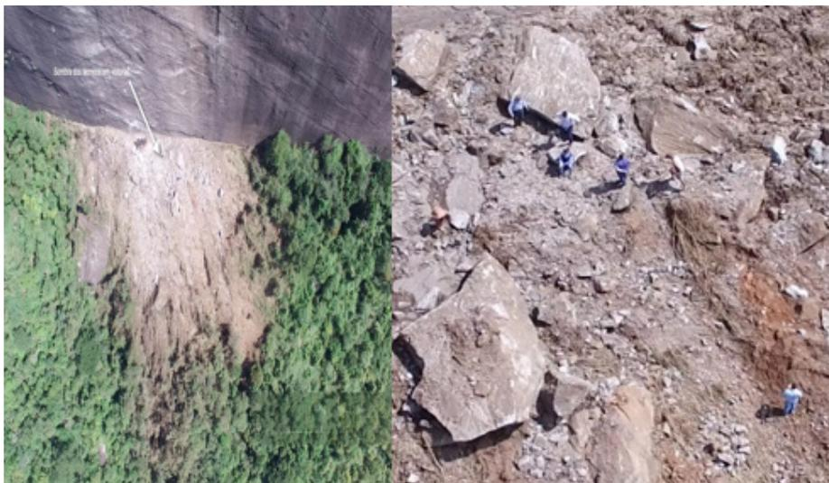
Figura 3 - Área remanescente no local do impacto da lasca com o bloco já existente na base do talude rochoso e detalhamento da fragmentação do bloco (Relatório Inspeção SUBPERD, 2018)
