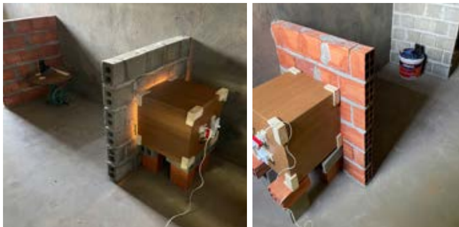
Figura 3 – Instrumentação do experimento com posicionamento da fonte artificial de calor nas faces externas e da câmera termográfica nas faces internas
