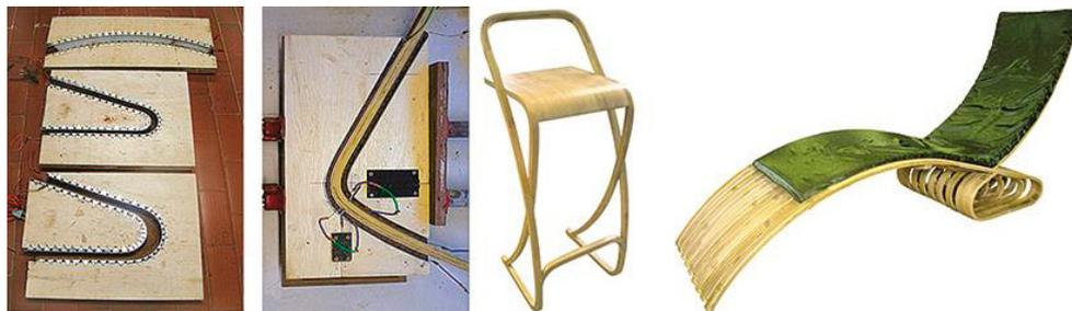
Figura 2 – Moldes e protótipos finalizados.
