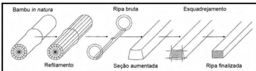
Figura 3: Etapas do processo de laminação do bambu.
