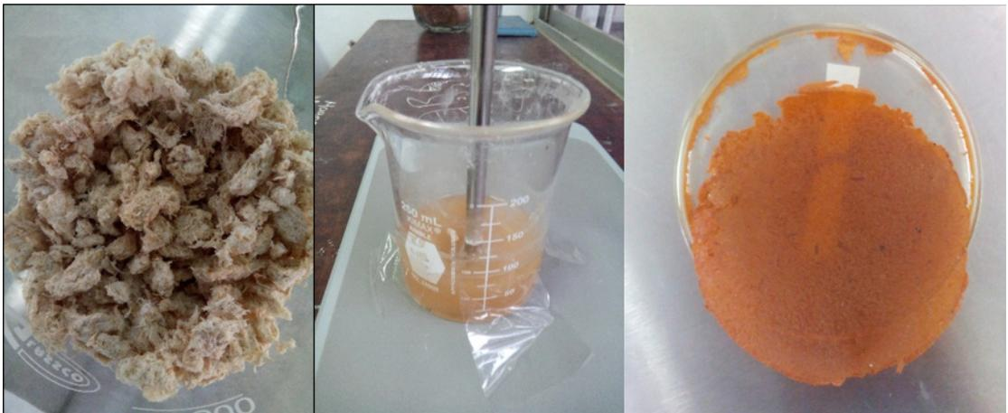
Figura 6. Transformación de la celulosa a rayón viscosa
