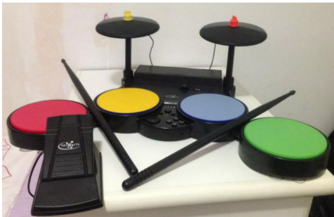
Figura 1: Bateria eletrônica portátil Guitar Hero, compatível com PS2, PS3, XBOX E WII. Não reproduz som sozinha. Precisa estar conectada ao Hardware e aos jogos que é compatível.
