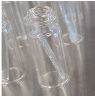
Figura 1. Viales con soporte de vidrio, como soporte para la formación de biopelícula de Geobacter sulfurreducens .
