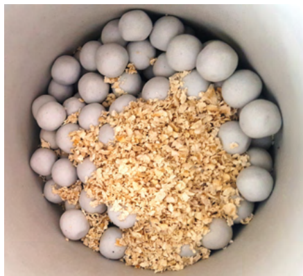
Figura 11: Bagaço de laranja pronto para a etapa de moagem dentro do moinho de bolas, na presença de 200 corpos moedores. Fonte: Arquivo pessoal
