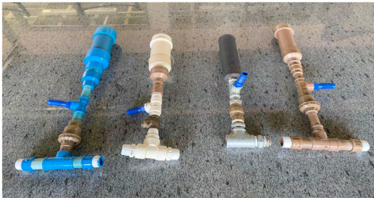
Figura 01 – Carneiros hidráulicos construídos
