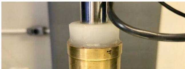
Figura 4 - Perda de água na junção do êmbolo com o cilindro do reservatório
