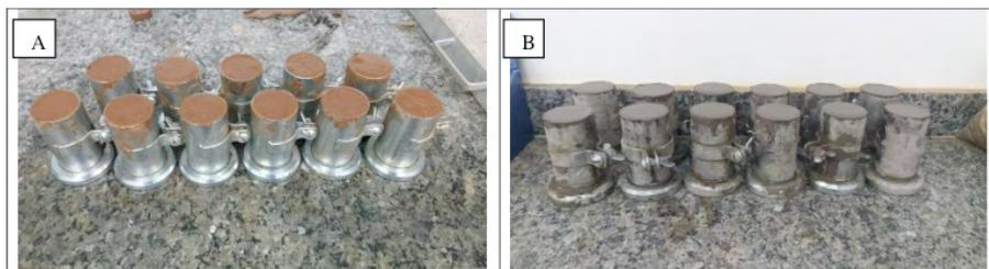
Figura 4 – Corpos de prova de argamassa moldados em formas de 50x100 mm, a esquerda (A) argamassa álcali-ativada, a direita (B) argamassa convencional de cimento Portland.
