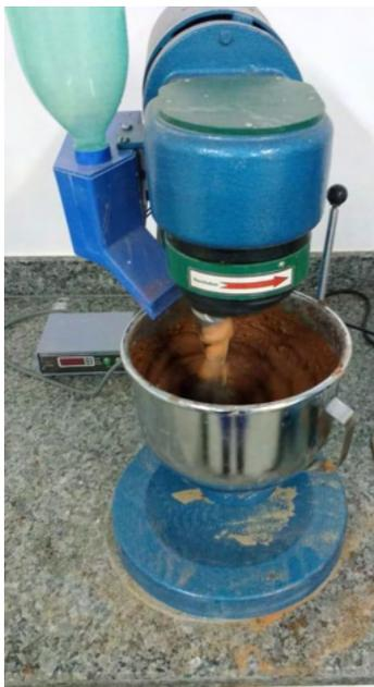
Figura 3 - Misturador mecânico utilizado para preparo da argamassa.
