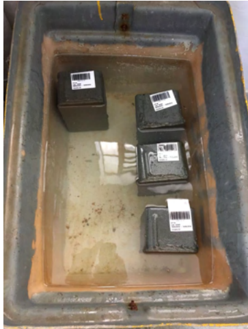
Figura 4a – Pavers imersos para posterior ruptura
