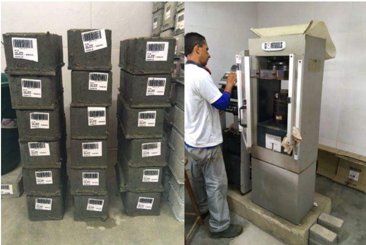
Figura 4b – Ensaio de resistência à compressão
