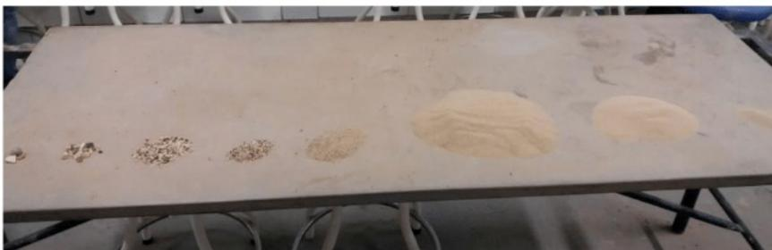
Figura 1– Agregado miúdo peneirado
