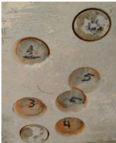
Figura 6 – Amostra após o arranchamento (Traço com cal)
