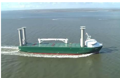
Figura 5- Embarcación que logra el empuje con cilindros verticales sobre su cubierta.
