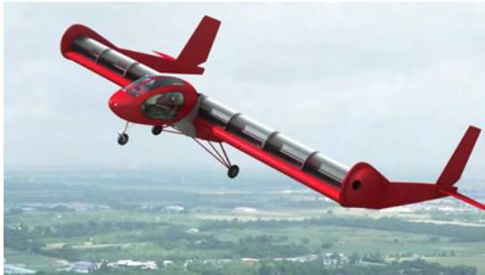
Figura 4- Aeromodelo con cilindro giratorio que sustituye al ala.
