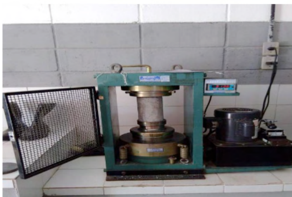
Figura 3 - Ensaio de compressão dos blocos de argamassas
